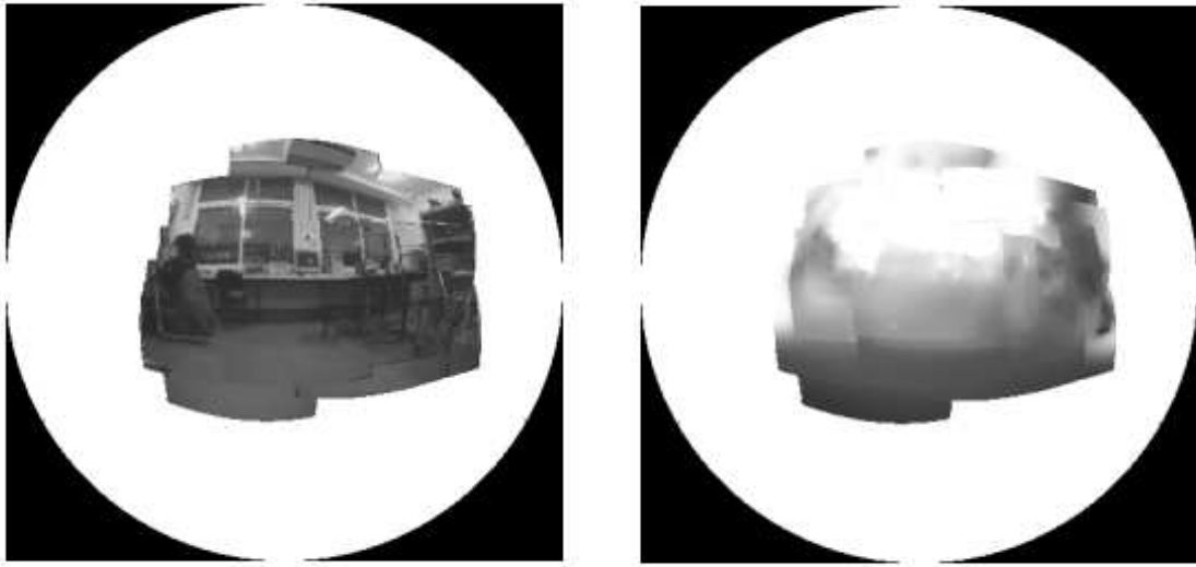
Figura 10: Representación espacial realizada por el robot tras varios movimientos de rotación. Las imágenes muestran las propiedades de color y profundidad percibidas
