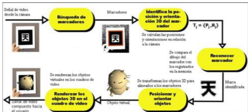
Figura 8. Funcionamiento de ARToolKit.
