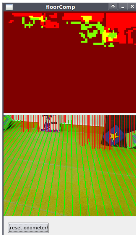
Figura 4.9: Captura de pantalla de floorComp. En la parte superior se ve gráficamente la clasificación (canal rojo para el floorColorCueComp, verde para floorPPSCComp). En la parte inferior se dibuja el modelo del suelo que se puede obtener del componente.
