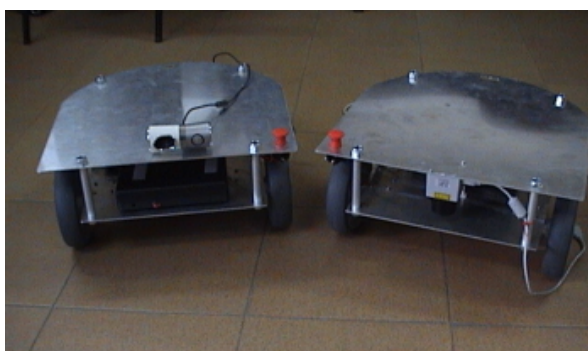
Figura 2.4: Fotografía de dos RobEx básicos a los que se les ha añadido una cámara (izquierda) y un escaner láser (derecha).
