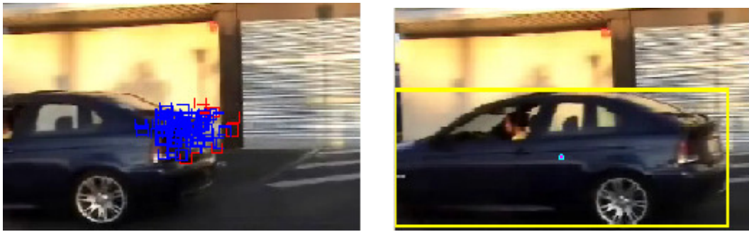
Figura : Influencia de la velocidad en el Filtro de Partículas y en el Filtro de Kalman
