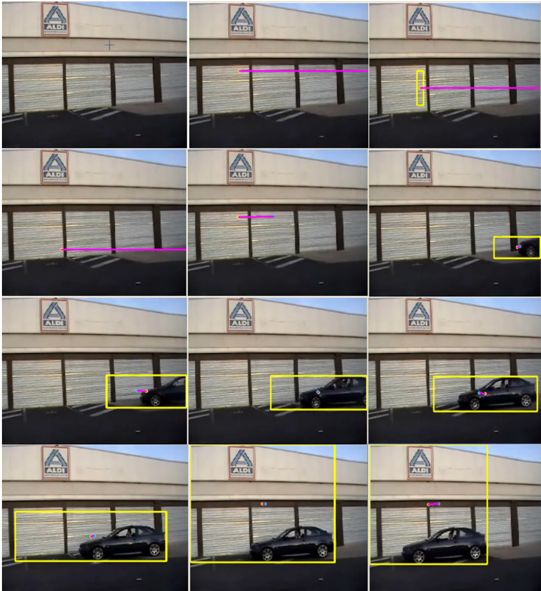
Figura 31. Prueba 1 de sustracción de fondo. Experimento 2. Umbral 20.
