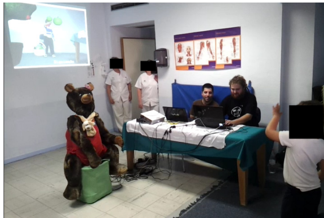
Figura 1: El robot Ursus en una sesión de neurorehabilitación en el Hospital Universitario Virgen del Rocío de Sevilla. El robot exhibe un comportamiento muy supervisado tanto a alto nivel, la terapia se organiza como una rígida secuencia de estados, en la que cualquier evento no tenido en cuenta obliga al técnico a decidir manualmente el estado en la misma, como a medio o bajo nivel, por ejemplo a la hora de construir las frases de refuerzo o decidir cuando emplearlas, pero también para decidir cuando aumentar el ritmo de las repeticiones, o su amplitud. Esto justifica la presencia de dos técnicos en la sesión (sentados junto a Ursus).
